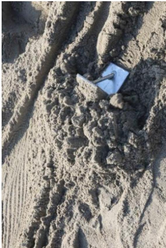
La Britany s'ensable à vive allure mais résiste mal aux fortes tractions. Ne pas hésiter dans ce cas à mettre plus de chaîne.
