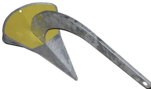
l'enfouissement et à la traction tout aussi bonnes. Avec « seulement » 4,5 kg, cette ancre légère a tenu jusqu'à 925 kg. De quoi voir venir pour un mouillage secondaire ! Autre avantage : une manipulation aisée par sa forme non agressive et compacte (pas de pelle pointue et absence de jas). Sa résistance structurelle a en revanche été éprouvée lors de nos essais avec une verge qui a eu tendance à se tordre sous la traction. Prix : 570 €.
