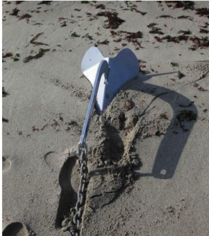
La Kobra s'ensable assez vite à la traction. Sous charge, elle chasse en douceur avant de finir par céder.
